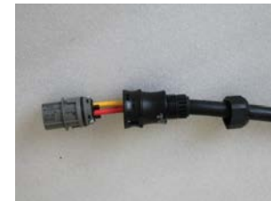
▲ Figura 4.16 Conecte los cables al terminal
