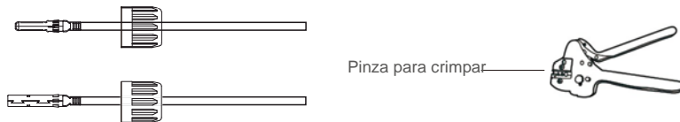
▲ Figura 4.10 Crimpe la clavija de contacto al cable
