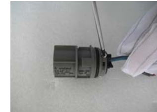
▲ Figura 4.16 Conecte los cables al terminal
